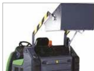
SYSTÈME DE RECHARGE HYDRAULIQUE DU BAC À DÉCHETS
